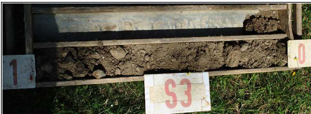
Obr.č. 8: Pohled na geologický profil sondy S3, hluboké 1,1 m. Do hloubky 1,0 m zastižena hlinito-písčítá navážka, středně ulehlá. Hloubení ukončeno na povrchu silně zvětralého granitu (syenitu) velmi málo pevného, třídy R5 , hlouběji s přechodem do mírně zvětralých , vibračním zarážením nevrtatelných skalních partií, třídy R4. Podzemní voda se v sondě neprojevila.
