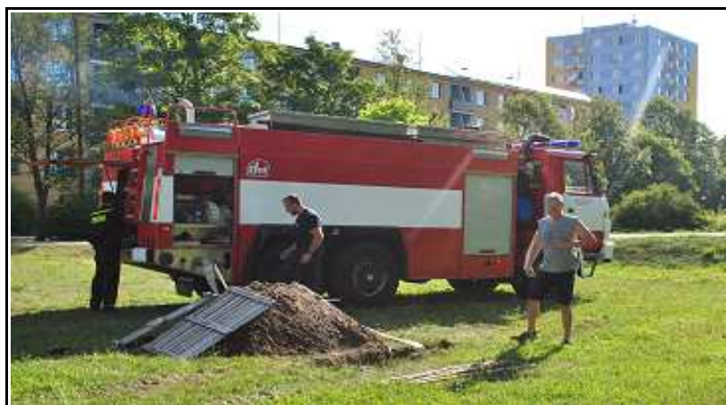
Obr.č. 3 a 4 : Ve vyhloubené sondě provedena 1 denní nálevová vsakovací zkouška k ověření propustnosti horninového profilu a určení koeficientu vsaku k_v . Hladina doplněna na úroveň 0,55 m pod terén.
