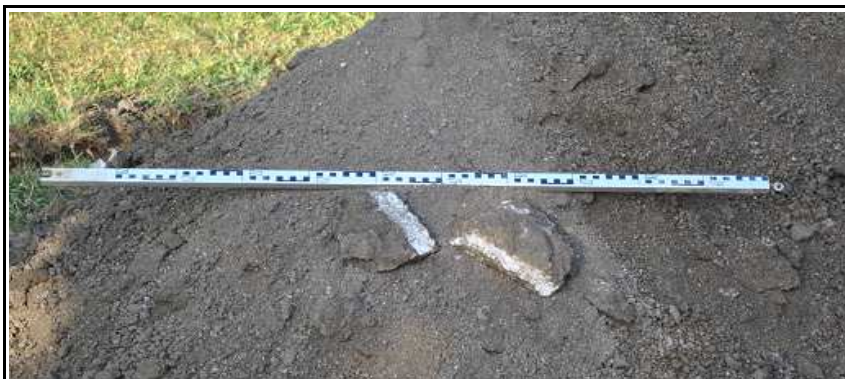
Obr.č. 2: Pohled na výkopový materiál sondy K1 hluboké 1,5 m. Pod vrstvou navážky - terénní úpravy 0,6 m mocné zastižen relikty hlinito-písčitého deluvia, od 0,8 m s přechodem do zcela zvětralého granitu, třídy R5. Hloubení ukončeno na povrchu navětralé, středně pevné skalní horniny, třídy R3 (viz úlomky).
