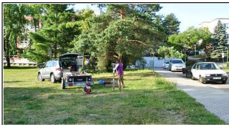
Obr.č. 3 a 4 : Ve vyhloubené sondě provedena 1 denní nálevová vsakovací zkouška k ověření propustnosti horninového profilu a určení koeficientu vsaku k_v . Hladina doplněna na úroveň 0,55 m pod terén.
