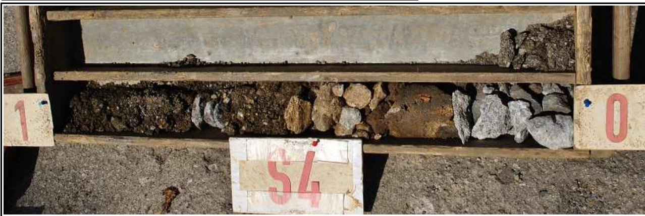
Obr.č. 10: Pohled na geologický profil sondy S4, hluboké 1,1 m. Pod betonovými deskami zastiženo vyrovnávací kamenité lože , v souhrnné tl. 400 mm. Hlouběji zastiženo žilné těleso zvětralého pegmatitu, pronikající silně zvětralým granitem (syenit) , třídy R5-R4. Hloubení ukončeno na povrchu mírně zvětralé horniny málo pevné, třídy R4 . Podzemní voda se v sondě neprojevila-
