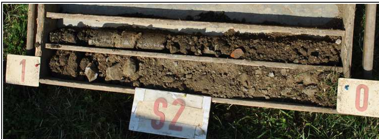
Obr.č. 6: Pohled do vzorkovnice na geologický profil sondy S2, hluboké 2 m. Do hloubky 1,8 m zastižena hlinito-písčítá navážka, středně ulehlá – od 0,8 m málo ulehlá . Hloubení ukončeno na povrchu zcela zvětralého granitu (syenitu), velmi ulehlého, třídy R6-R5. Podzemní voda se v sondě neprojevila.
